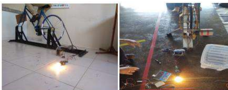
Figura 09– Funcionamento do Sistema Bicicleta-Dínamo na bicicleta 1 e 2
