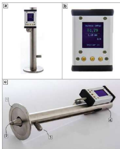
Figura 1: Durômetro Portátil para Madeiras (DPM3): a) equipamento na posição vertical, b) detalhe do painel eletrônico, c1) flange, c2) endentador, c3) manípulo e c4) suporte principal. Fonte: DE ASSIS, 2015; DE ASSIS et al., 2017.
